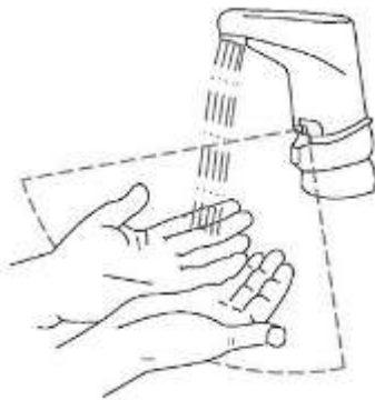
Figura 83 - Vista en elevación frontal de una grifería abierta accionada por sensor, con las manos en posición de lavado
