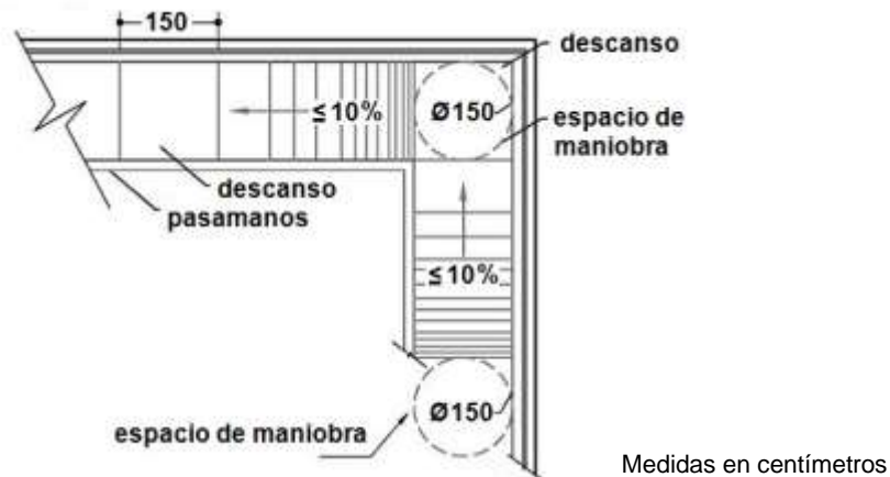
Figura 20 - Vista en planta esquemática de una rampa de dos ramas perpendiculares, donde se grafican los espacios de maniobra en descansos y en el sector inmediato al comienzo
