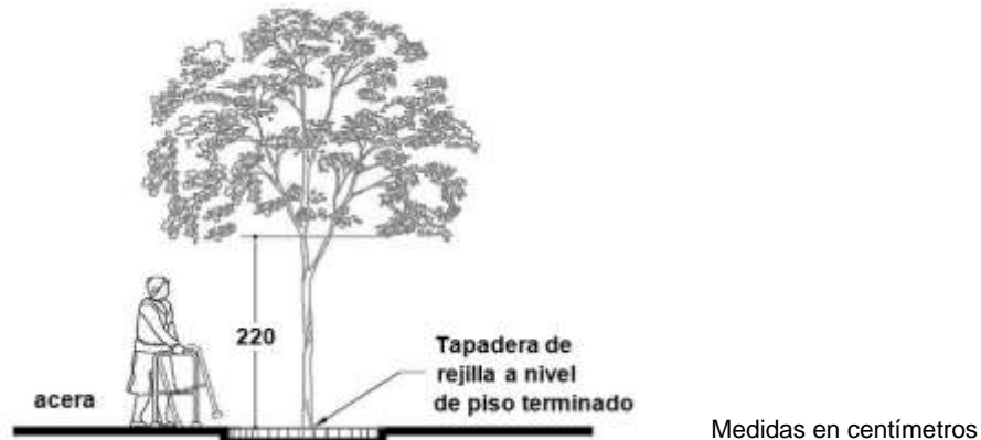
Figura 43 - Vista en elevación frontal de una persona usuaria de ayuda técnica aproximándose a la vegetación con altura mínima de 220 cm y con una parrilla a nivel de piso terminado que no obstaculiza la vía de circulación peatonal
